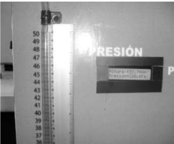
Figura 10.- Prueba de calibración del sistema de medida
